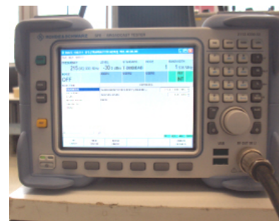
Abb. 5.5.: DAB Testsender SFE (R&amp;S)
