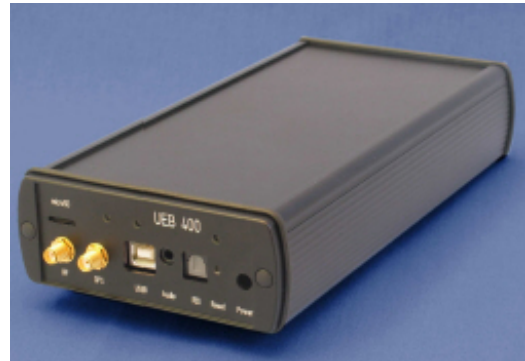
Abb. 4.13.: DAB Messempfänger - UEP 400 USB[VAD09] (Foto: VAD GmbH)
