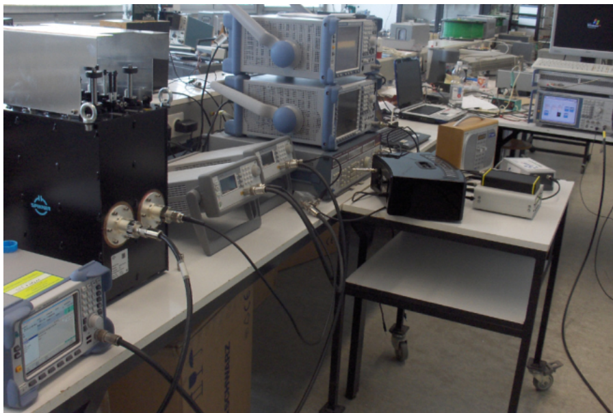
Abb. 5.1.: Messaufbau der Schutzabstandsmessung im Labor der FH-KL
